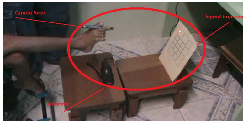
Figura 3. Detecção da luz laser invadindo a área de uma tecla
