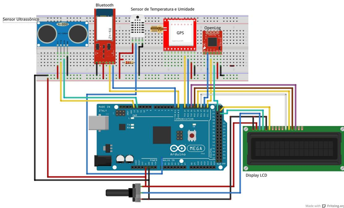
Figura 1. Prototipação da Ligação dos Componentes (Fonte: os autores)
