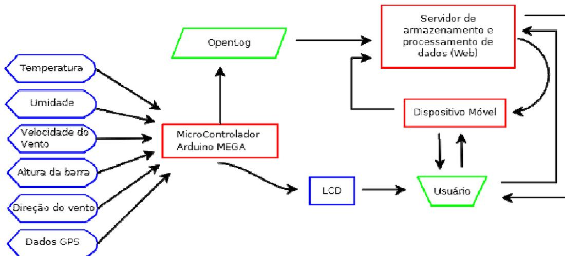
**Figura 2. Arquitetura do Sistema de Apoio ao Controle PRD (Fonte: os autores)**
